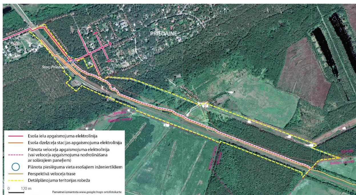
Attēls 29. Esošais un plānotais apgaismojums detālpārplānojuma teritorijā
